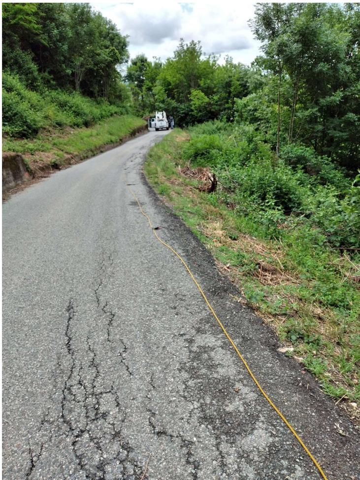
Foto 13 – Stendimento sismico
